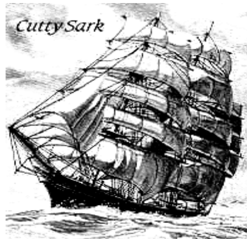
Le clipper CUTTY STARK, lancé le 22 novembre 1869 Long de 64,62 mètres, ce trois-mâts carré peut porter jusqu'à 4000 m 2 de toile
